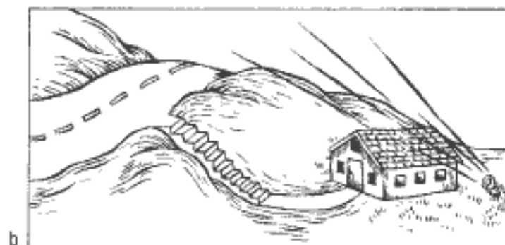
Figura 7-6: a) Casa en terreno con pendiente en caída; b) casa por debajo del nivel de la carretera de llegada.
